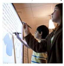
используется пишущее устройство, которым может быть либо специальный электронный карандаш, который часто называют электронным стилусом (выглядящий как пластмассовый стержень со скруглённым концом, обычно имитирующий по форме маркер).
