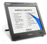
Интерактивная панель - дают возможность управлять демонстрацией материалов с рабочего места, проещируя изображение на экран любых размеров (с помощью проектора, подключенного к тому же компьютеру, что и интерактивная панель).
