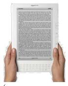
КПК, планшетных ПК или субноутбуков является ограниченная функциональность, а также существенно большее время автономной работы. Последнее достигается за счет использования технологии E-ink, так называемой «электронной бумаги». Дисплей,
